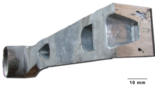
Rys. 4. Przykładowy odlew kompozytowy z widocznymi wadami strukturalnymi w przekroju poprzecznym Fig. 4. Selected composite cast with visible defects in cross section
