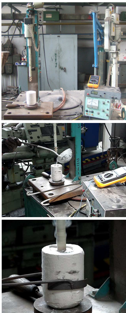
Rys. 3. Wybrane etapy wytwarzania struktury tiksotropowej Fig. 3. Selected stages of creating a rheocast structure
