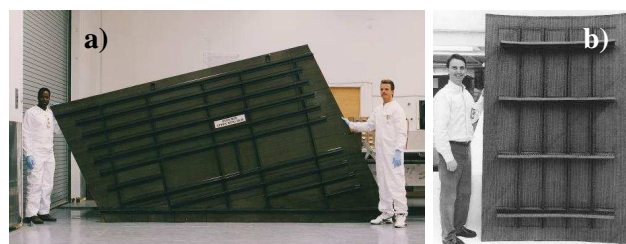
Rys. 9. Panel skrzydła (a) oraz panel poszycia kadłuba (b) wykonane na bazie zszywanych preform z włókna węglowego [1]
