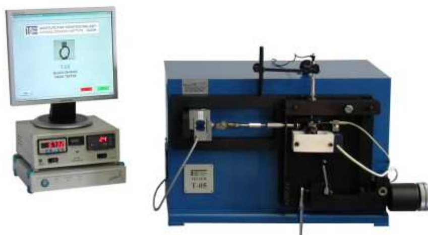
Rys. 1. Tester T-05 typu rolka - klocek do badań własności trybologicznych
