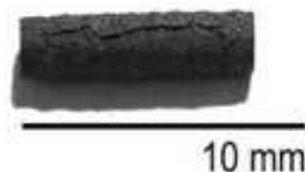
Rys. 8. Wypraska Ti 3 Al+Al 2 O 3 po wyciskaniu 6→4 Fig. 8. Powder metallurgy compact of Ti 3 Al+Al 2 O 3 (HE 6→4)
