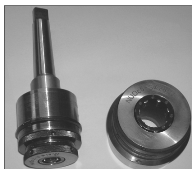
Rys. 1. Głowica rolkowa typu NUDc-s zaprojektowana do badań nagniatania kompozytów
