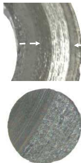
Rys. 8. Widok śladu zużycia kompozytowej tarczy Al25Cs100I i współpracującego z nią żeliwnego trzpienia
