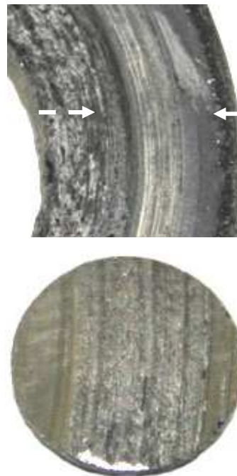
Rys. 7. Widok śladu zużycia kompozytowej tarczy Al25Cs100II i współpracującego z nią żeliwnego trzpienia
