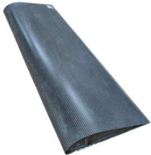
Rys. 9. Kompletny demonstrator lotki wykonany z preimpregnatu utwardzanego w worku próżniowym, poza autoklawem Fig. 9. Complete aileron demonstrator made of VBO prepreg
