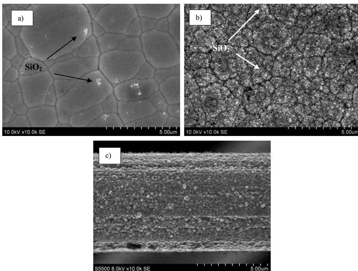
Fig. 1. Composite layer of Ni-P/SiO<sub>2</sub> on PET substrate obtained from glycine buffered bath with pH 8.5, deposition time 60 min: a) SiO<sub>2</sub> concentration 10 g/l; b) 30 g/l SiO<sub>2</sub>; c) Ni-P/SiO<sub>2</sub> on carbon fibreRys. 1. Powłoka kompozytowa Ni-P/SiO<sub>2</sub> na PET otrzymana z roztworu glicynowego, pH 8,5, czas metalizacji 60 minut: a) 10 g/l SiO<sub>2</sub>; b) 30 g/l SiO<sub>2</sub>; c) powłoka Ni-P/SiO<sub>2</sub> na włóknie węglowym
