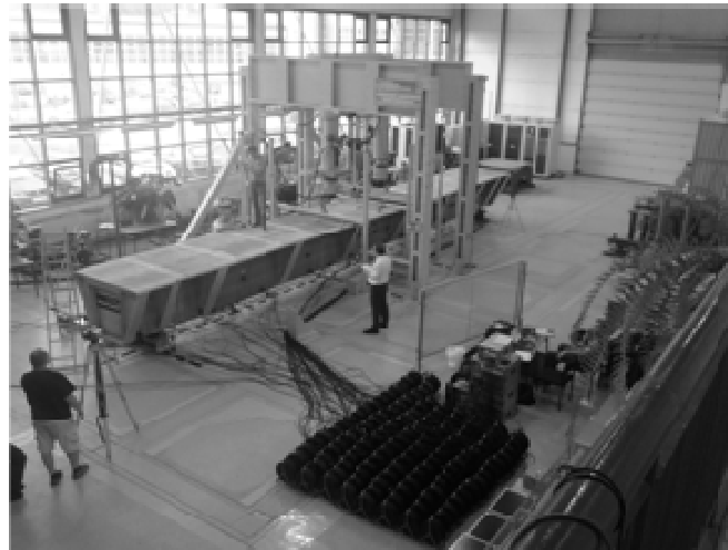
Fig. 2. Tested structure installed on test bench with AE sensors attached Rys. 2. Badany obiekt zamontowany na stanowisku badawczym z czujnikami AT
