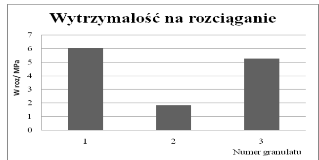
Rys. 3. Wytrzymałość na rozciąganie wyznaczoną metodą „testu brazylijskiego” spieczonych kształtek w 900°C (granulaty I, II, III)
