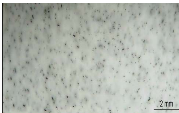
Rys. 2. Rozmieszczenie cząstek proszku żelaza w kompozycie \text{Al}_2\text{O}_3\text{-Fe} otrzymanym z masy lejnej o stężeniu fazy stałej 50% obj. po spiekaniu w 1470^\circ\text{C}/1 \text{ h} w piecu próżniowym
