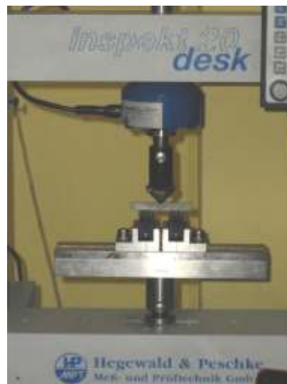
Rys. 3. Widok maszyny wytrzymałościowej wraz z zamocowaną próbką SENB
