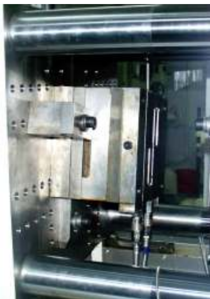
Rys. 2. Widok formy wtryskowej dwugniazdowej Fig. 2. View of double-cavity injection mould
