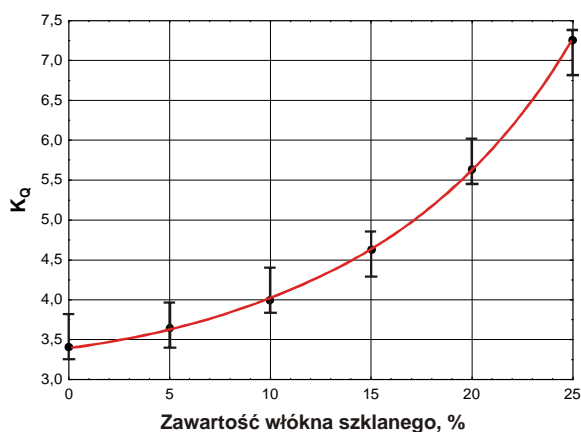
Rys. 5. Zależność współczynnika intensywności naprężeń od zawartości włókna szklanego
