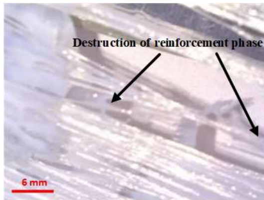
Fig. 4. Destruction of reinforcement phase Rys. 4. Zniszczenie fazy umocnienia
