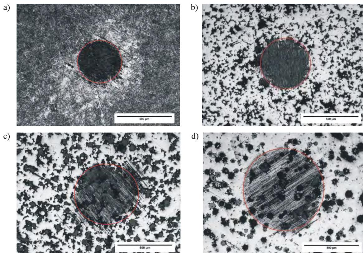
Fig. 5. Microscope photographs of wear on specimen surface: a) 100% Ti-6Al-4V, b) 80% Ti-6Al-4V + 20% Al<sub>2</sub>O<sub>3</sub>, c) 80% Ti-6Al-4V + 20% HAp, d) 80% Ti-6Al-4V + 20% YSZRys. 5. Obraz mikroskopowy zużycia powierzchni próbek: a) 100% Ti-6Al-4V, b) 80% Ti-6Al-4V + 20% Al<sub>2</sub>O<sub>3</sub>, c) 80% Ti-6Al-4V + 20% HAp, d) 80% Ti-6Al-4V + 20% YSZ
