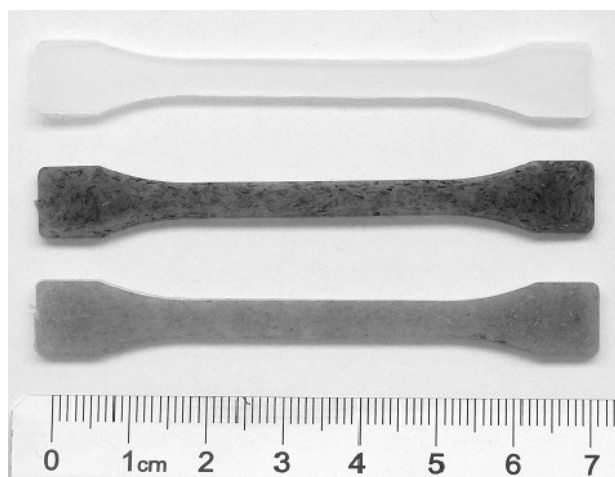
Rys. 2. Wygląd badanych materiałów: LDPE, LDPE / juta i LDPE / konopie
