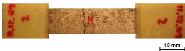
Fig. 2. Broken CF/Al-MMC specimen after tensile test Rys. 2. Próbka CF/Al-MMC po badaniu
