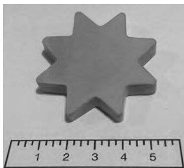
Fig. 6. Photograph of sintered composite sample fabricated by gelcasting Rys. 6. Zdjęcie kształtki kompozytowej wykonanej metodą gelcasting
