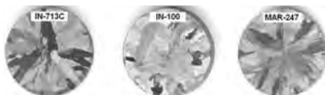
Fig. 7. Macrostructure of charge materials (casting diameter 30 mm) Rys. 7. Makrostruktura wsadu wyjściowego
